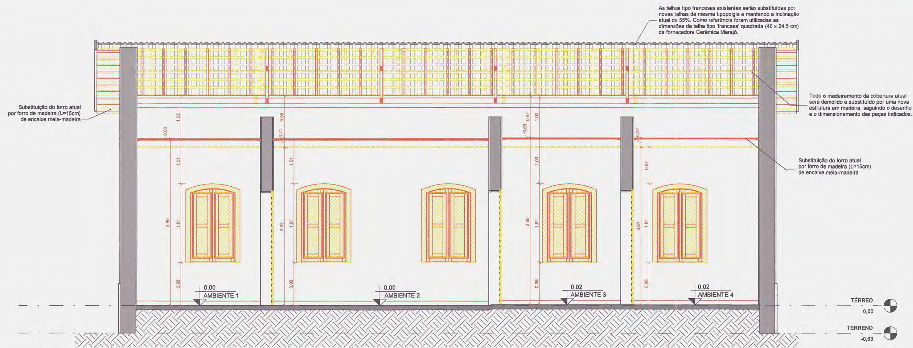
1 CORTE B - DEMOLIR E CONSTRUIR 1:50
