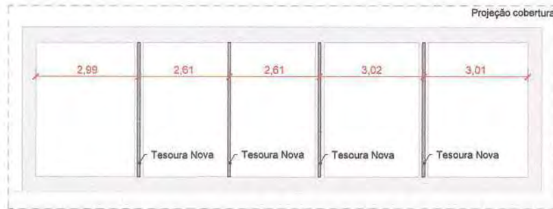
8 PLANTA DE REFERÊNCIA - TESOURAS NOVAS 1: 150
