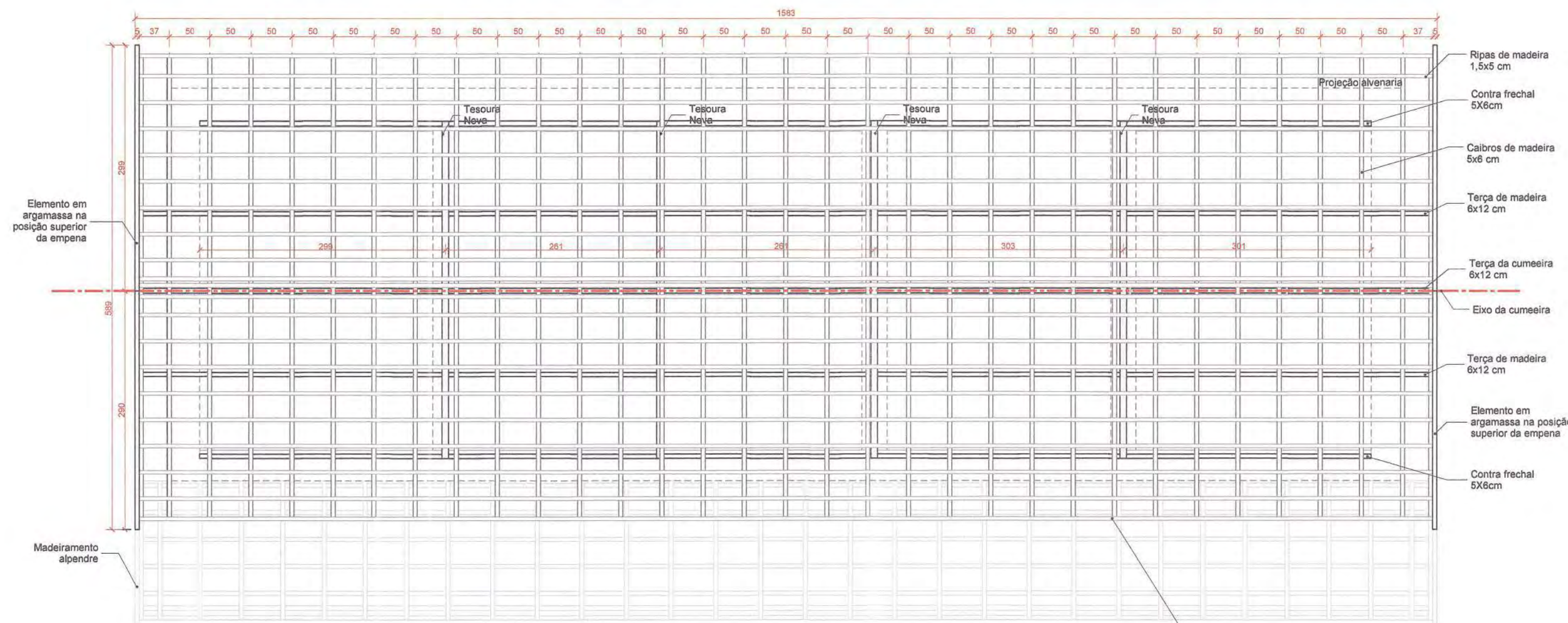
2 PLANTA COBERTURA - MADEIRAMENTO 1: 60
